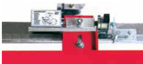
controlled speed limiter detail (VC) reduktor prędkości
